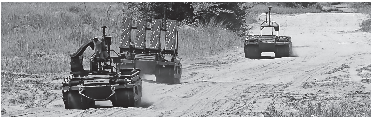
Многоцелевая платформа НРТК «Курьер» может нести на себе гранатомёт, пулемёт, систему радиоэлектронной борьбы и даже служить в качестве машины разминирования
